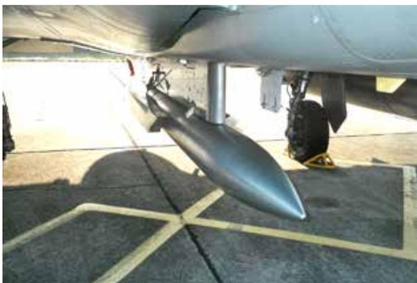
Un missile ASMP fixé sous un Mirage 2000N. © PWG.
