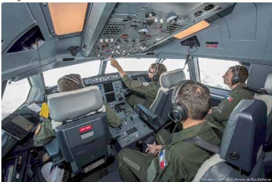
Le cockpit dernier cri de l'Airbus A330-200 MRTT est dérivé de l'avion civil. © Armée de l'Air.
